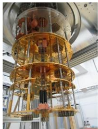
理研の超電導量子コンピュータ
